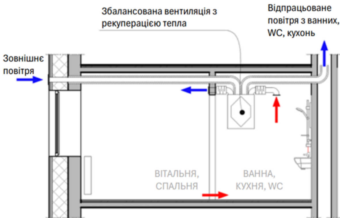
Рисунок 4.5 - Кімнатні припливно-витяжні блоки з рекуперацією тепла (ліворуч) і квартирні збалансовані вентиляційні блоки з рекуперацією тепла (праворуч)
