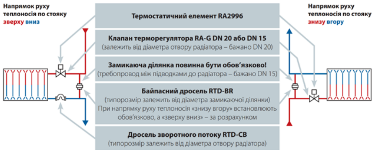
Рисунок 4.13 - Схема радіаторного регулювання для однотрубно́ї системи
