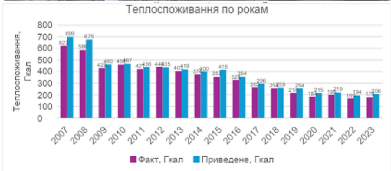
Рис. 2. Багатоквартирний будинок після термосанації та зміна споживання
